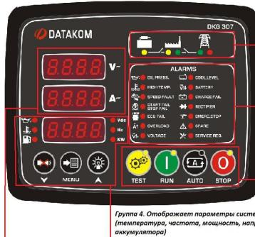
Группа 1. Мнемоническая диаграмма отображает работу генераторной установки
