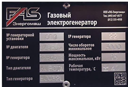
Рис. Табличка-шильда паспортных данных генераторной установки
